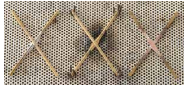
Lötlehre (Mitte) und vorgefertigte Windverbände.
