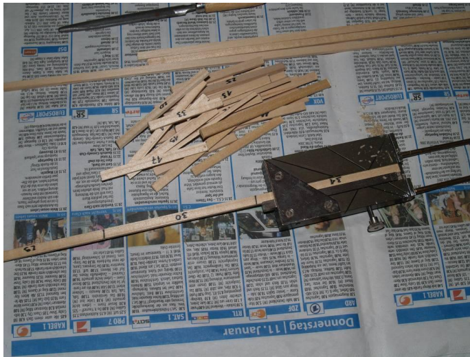
Bild 2 Anzeichnen und schneiden der Schwellen
